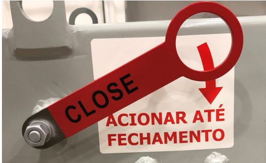
Palanca de cierre Dispositivo exclusivo LBS
