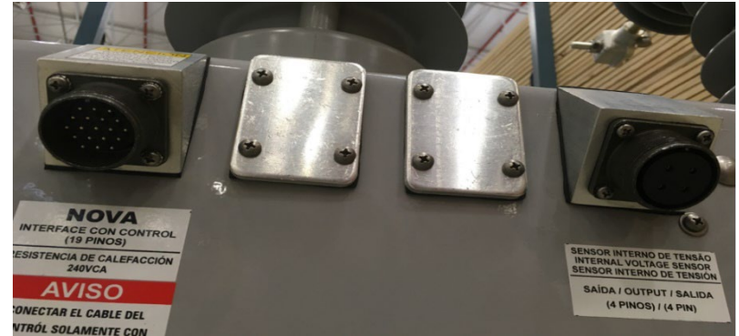
Conexión individual para comando y medición de voltaje, ubicada en la parte trasera del equipo.
