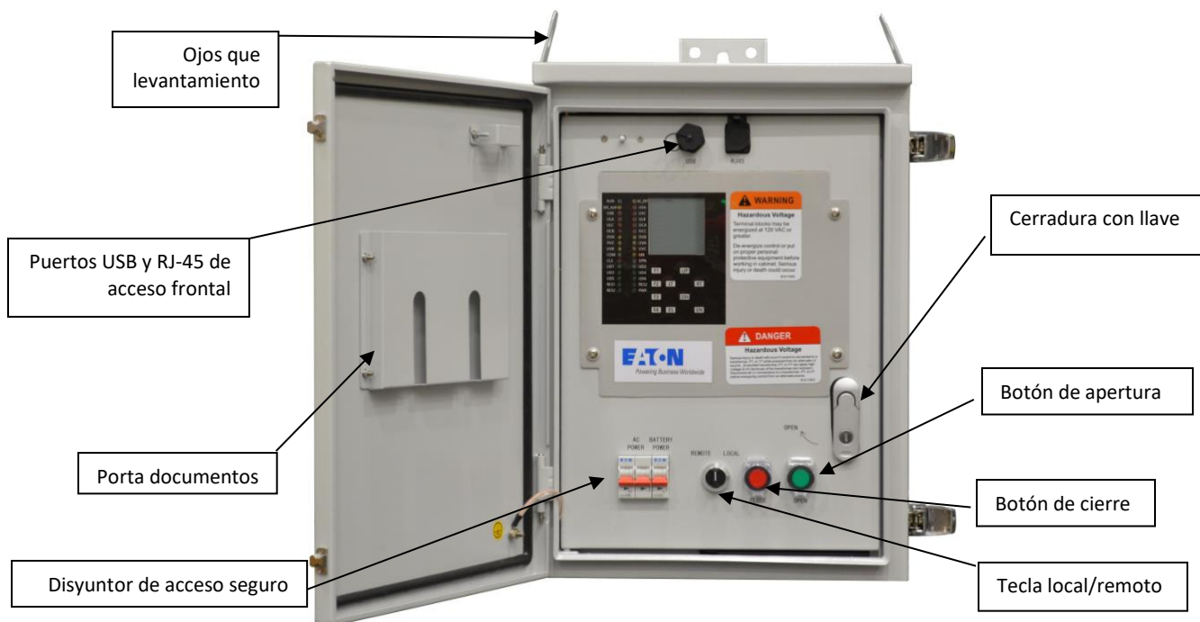
Figura 4: Tablero delantero del control LBC con la puerta delantera abierta
