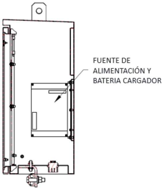
Figura 14: Vista lateral del tablero del control LBC
